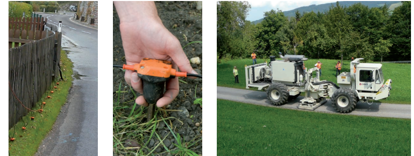
Die Geophone werden entlang der Messlinie ausgelegt.
